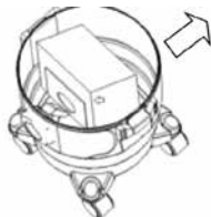
2. Retirez le filtre en papier. * Filtre à papier en option
