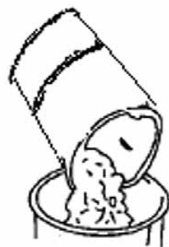
3. Svuotare il contenitore della polvere.
